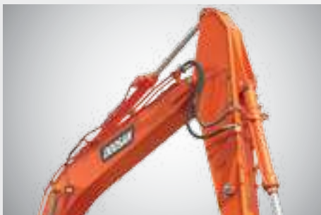
Прочность – Улучшенные стрела и рукоять
