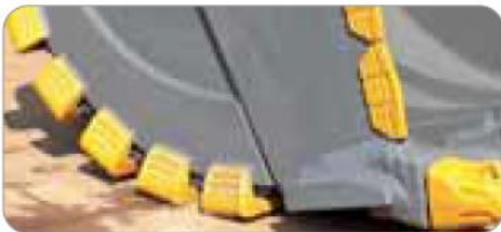
HSQR 500HB МЕХАНИЧЕСКАЯ ЗАЩИТА БОКОВЫХ КРОМОК КОВША
