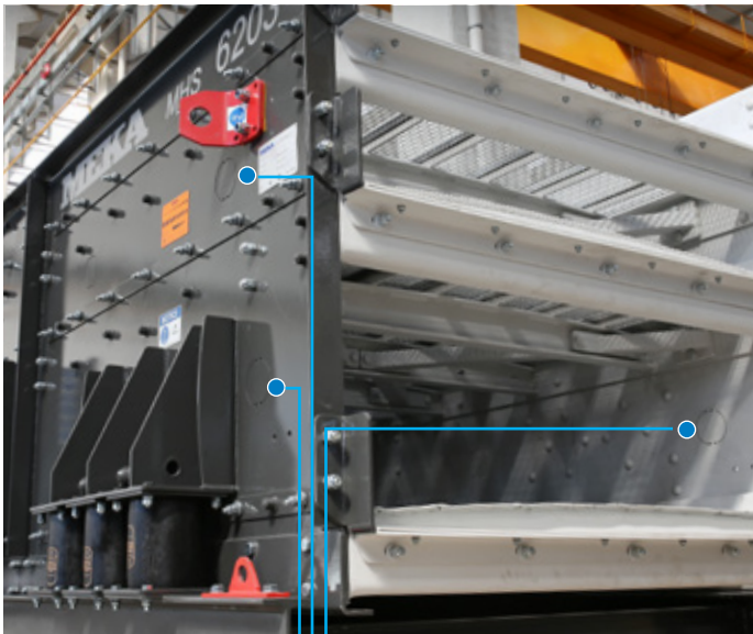
Переоборудование в грохот с промывкой - легко и быстро.
