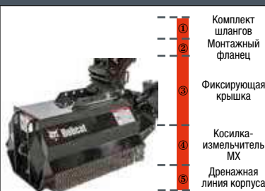
Косилка-измельчитель. Машина должна быть оснащена закрытой кабиной.
