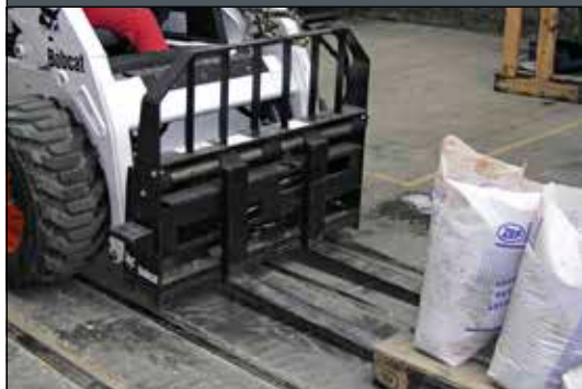
Гидравлические палетные вилы. Задняя рама и 2 зуба с гидравлической регулировкой.
