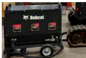
Станция быстрой зарядки Р. 192
