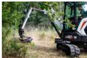
Косилка-измельчитель с автоматическим выравниванием Р. 182
