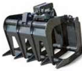
Захват для корней. Рекомендуется использовать предохранительный клапан линии 6684646 на машинах S450/T450 и более крупных моделях.
