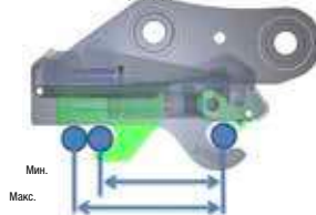
Быстросъемный механизм типа Pin Grabber
