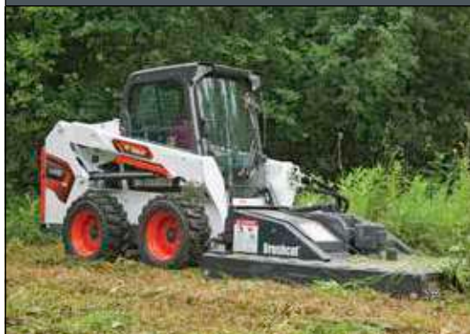
Роторный кусторез Brushcat™. В стандартной комплектации оснащается ножом, смещенным на 7 см, и передними колесами. Высота резания 7,6 см.
