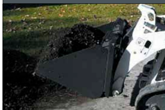
Универсальные ковши. Имеют предварительно просверленные отверстия для болтового крепления режущей кромки или зубьев.
