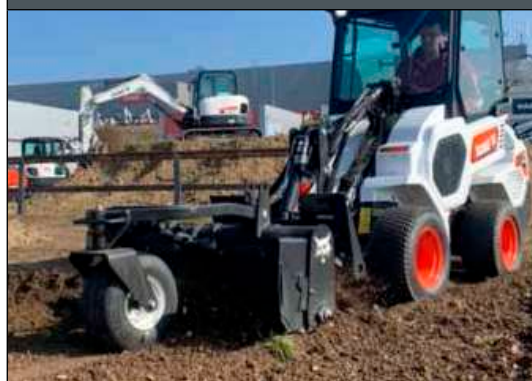
Почвенный аэратор. Погрузчик должен быть оснащен комплектом управления навесным оборудованием.
