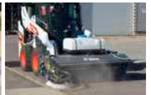
Подметальная щетка с бункером и открытой рамой для тяжелых условий эксплуатации Р. 100
