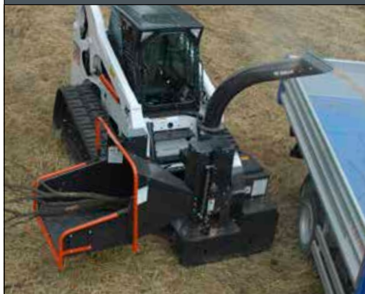
Измельчитель древесных отходов. Погрузчик должен быть оснащен 7-контактным комплектом управления.
