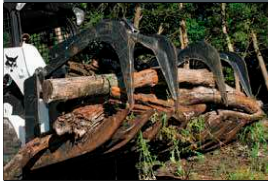
Захват для корней. Рекомендуется использовать предохранительный клапан линии 6684646 на машинах S450/T450 и более крупных моделях.
