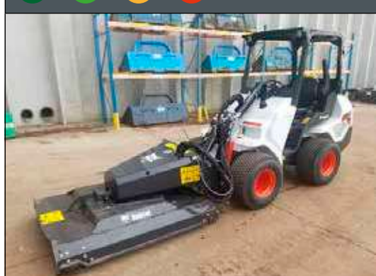
Роторный кусторез Brushcat™. В стандартной комплектации оснащается ножом, смещенным на 7 см, и передними колесами. Высота резания 7,6 см.
