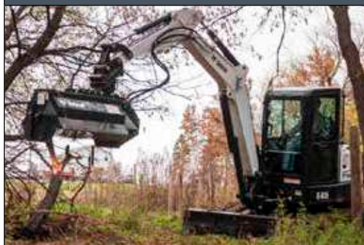
Косилка-измельчитель. Машина должна быть оснащена закрытой кабиной.
