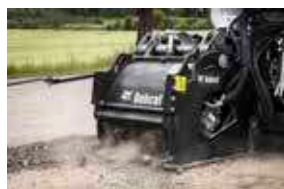
Холодная фреза с автоматическим выравниванием Р. 134
