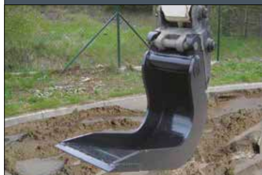
Ковш для глины. Тип креплений зависит от системы навески.
