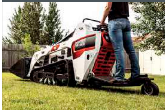
Откидная платформа для оператора. Нет специальных требований.
