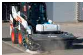
Подметальная щетка с бункером и открытой рамой для тяжелых условий эксплуатации P. 258
