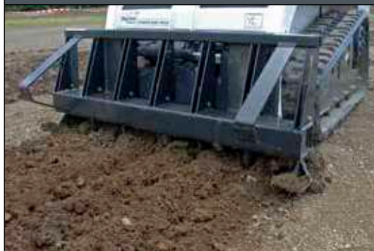
Кирковщик. Включает две направляющие и пять зубьев для работы на глубине.
